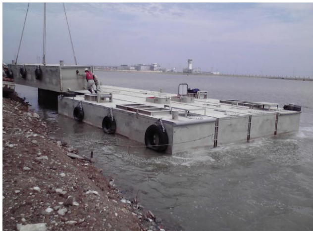
※神戸空港内 バージアンローダー船 配砂管支持台船として使用
