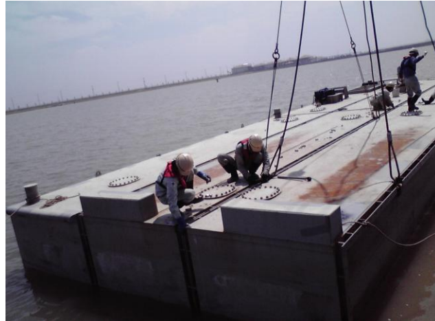
※神戸空港内 バージアンローダー船 配砂管支持台船として使用
